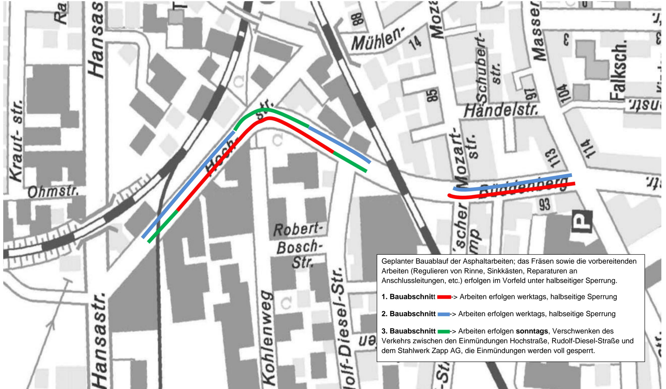
Geplanter Bauablauf der Asphaltarbeiten; das Fräsen sowie die vorbereitenden Arbeiten (Regulieren von Rinne, Sinkkästen, Reparaturen an Anschlussleitungen, etc.) erfolgen im Vorfeld unter halbseitiger Sperrung.
